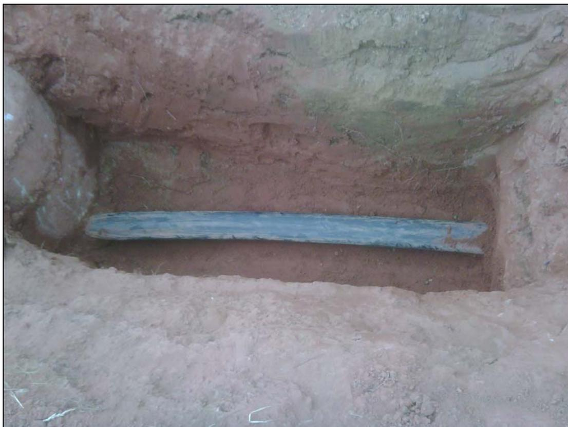
**Abb. 4:** Abgeplattete Abwasserleitung von der Deponie Fitten
